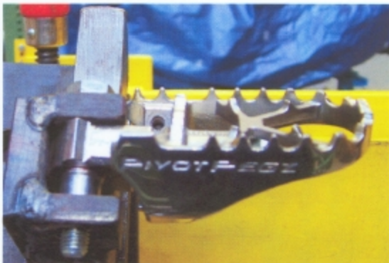
Bild: Prüfaufbau mit Schweißkonstruktion
